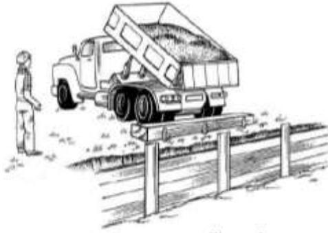
**Figura 3:** Bloques de tope para impedir que los camiones volquetas se deslicen dentro de la excavación al descargar en marcha atrás.
